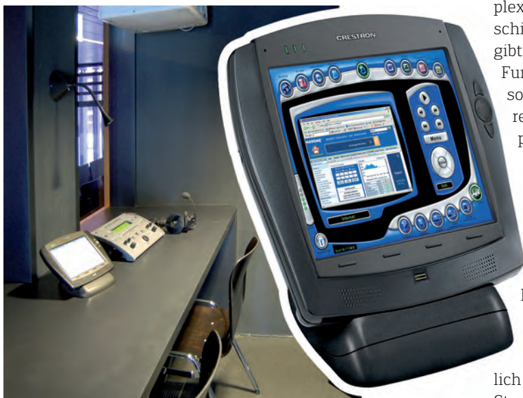
↑ Ein mobiles Touchpanel kommuniziert per W-LAN mit den Steuerungen. Je eine Dockingstation steht im Multifunktionsraum und im Regieraum des Großen Hörsaals.
