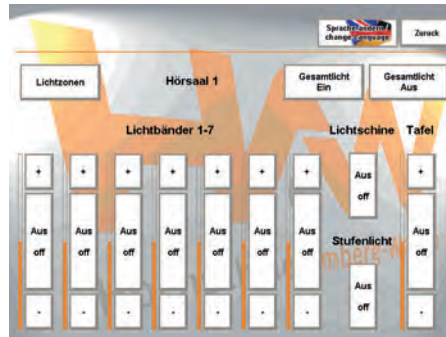
↑ Das Licht kann für jedes Lichtband einzeln, für vordefinierte Lichtzonen oder für den ganzen Raum geschaltet und gedimmt werden.
